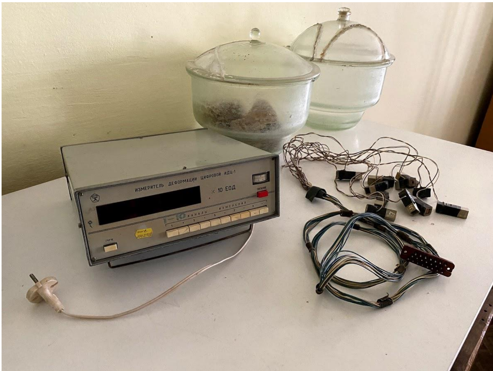
Прилад ИДЦ, тензометричні наголовники для моделей паль
