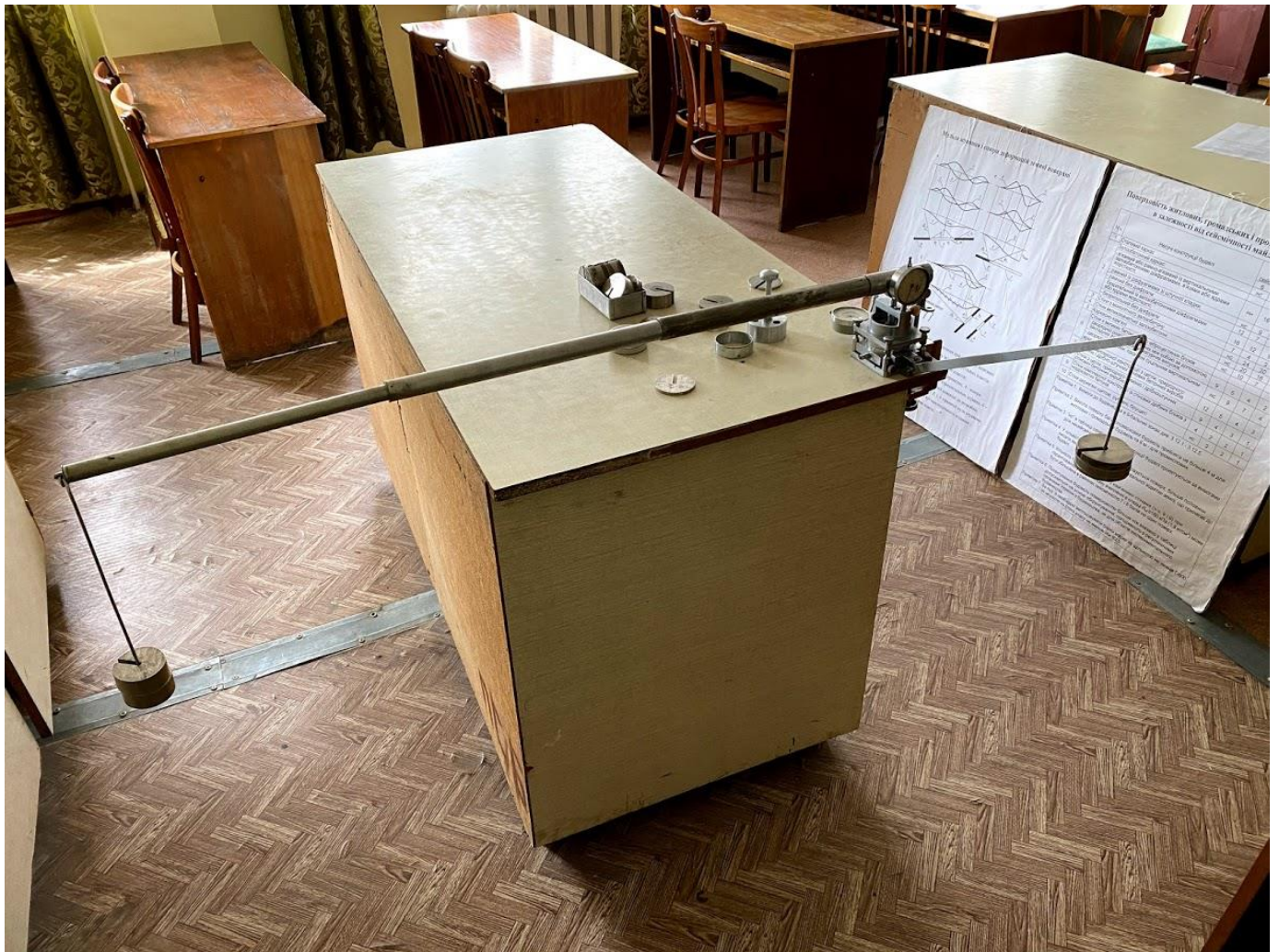
Зсувний прилад конструкції Літвінова (польова лабораторія)
