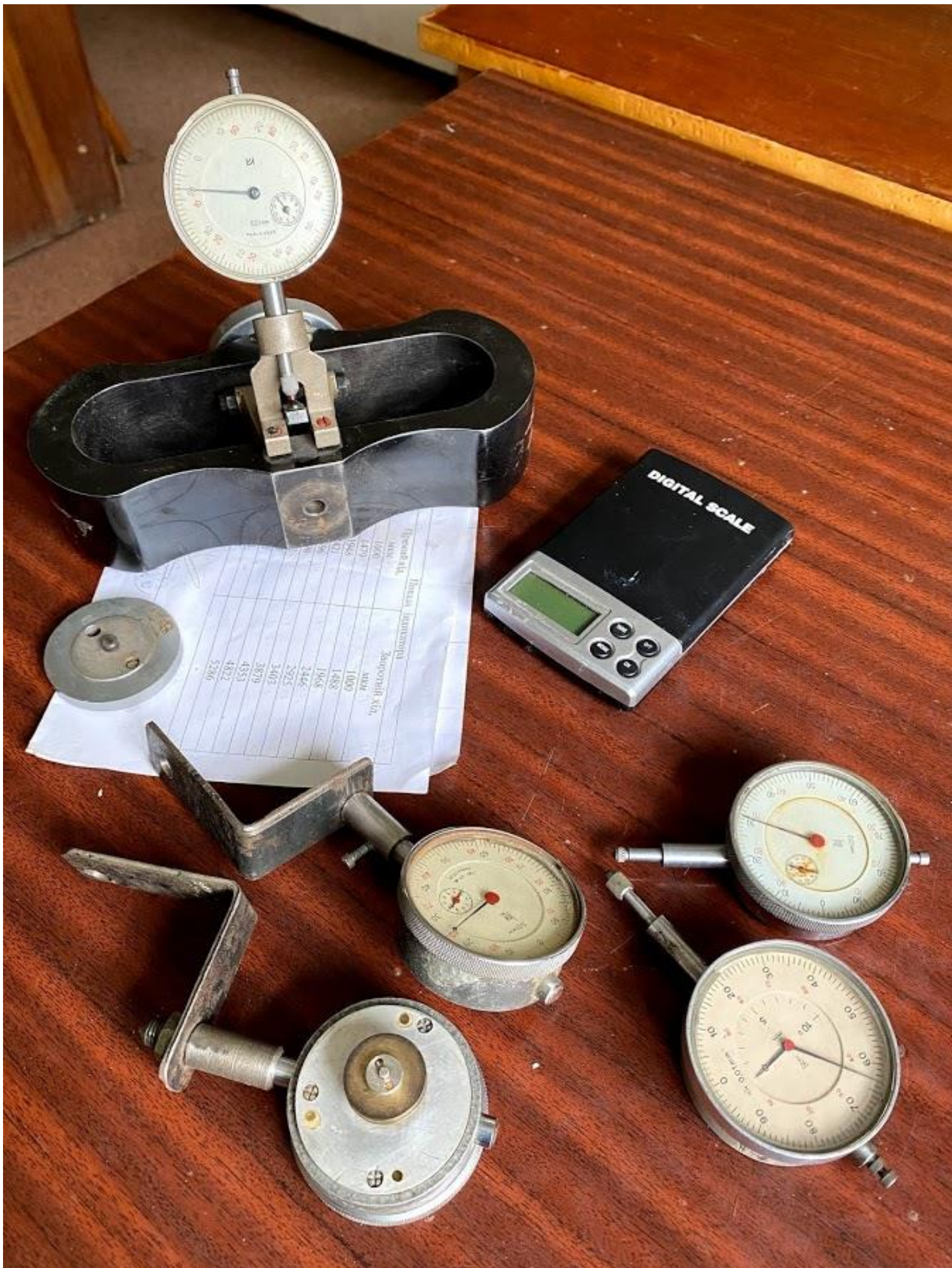
Вимірювальна апаратура (динамометр, ваги, індикатори годинникового типу, прогиноміри)
