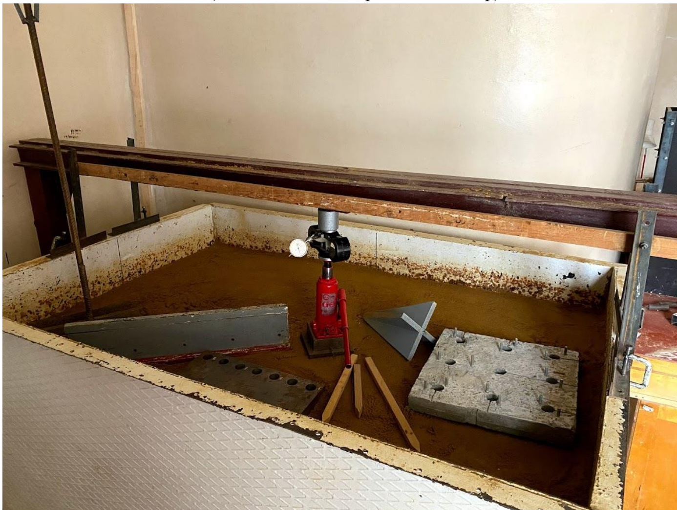
Лоток для фізичного моделювання з моделями фундаментів (встановлений домкрат, динамометр)
