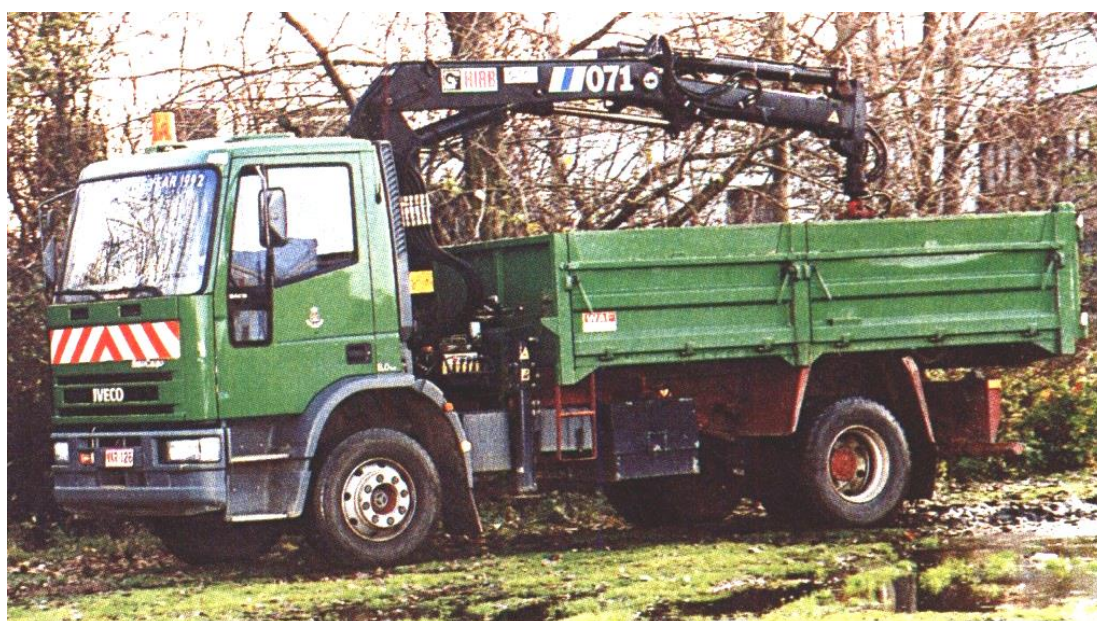
Рис. 6.10. Загальний вид автомобіля IVECO EuroCargo ML150E18 з консольним краном
