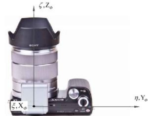
Рис. 5. Система координат зв'язана з фотокамерою в площині горизонту
