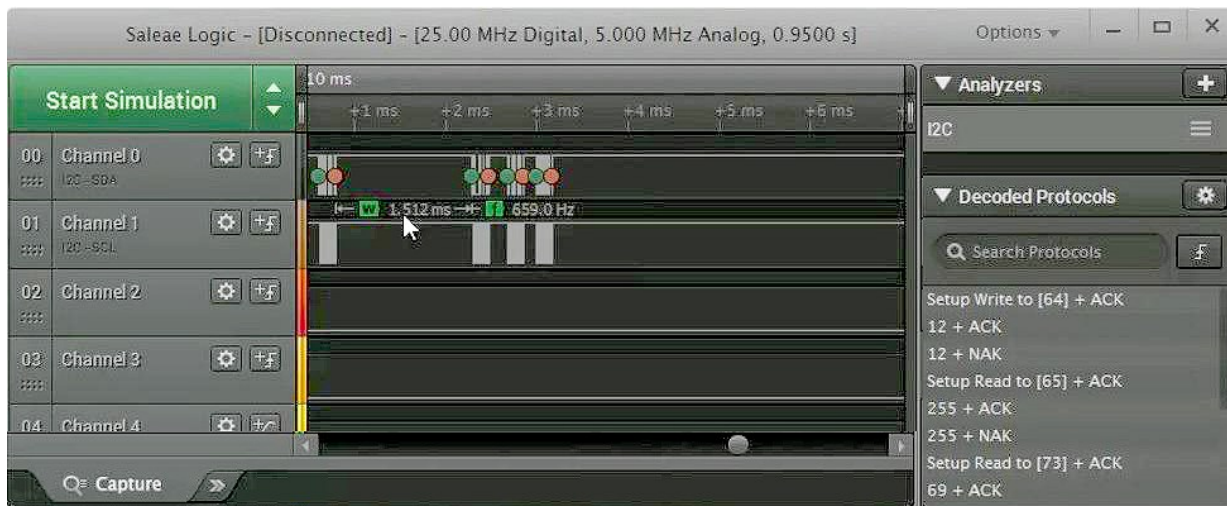
Рис.2. Аналіз та декодування інформації шини I2C
