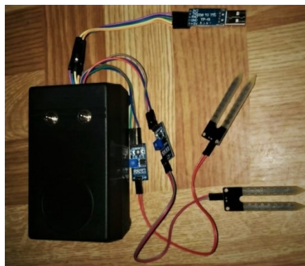
Рис. 3 Апаратна реалізація підсистеми передавання даних про вологість ґрунту
