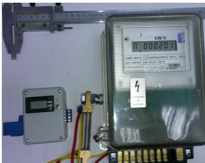
Рис. 3 – Внешний вид разработанного счётчика энергии (слева) рядом с промышленным образцом
