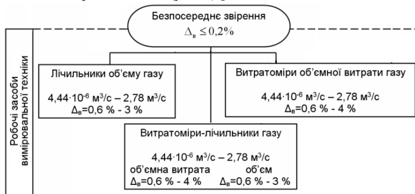
Рис. 1. Фрагмент повірочної схеми [8]
