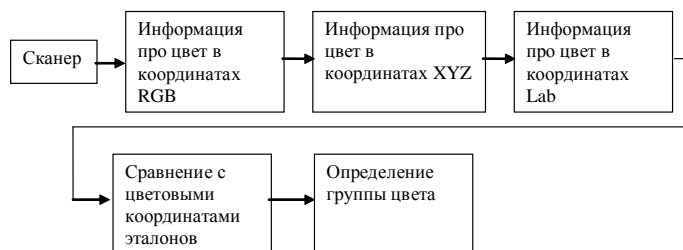
Рис. 1. Структурная схема определения группы цвета волокна
