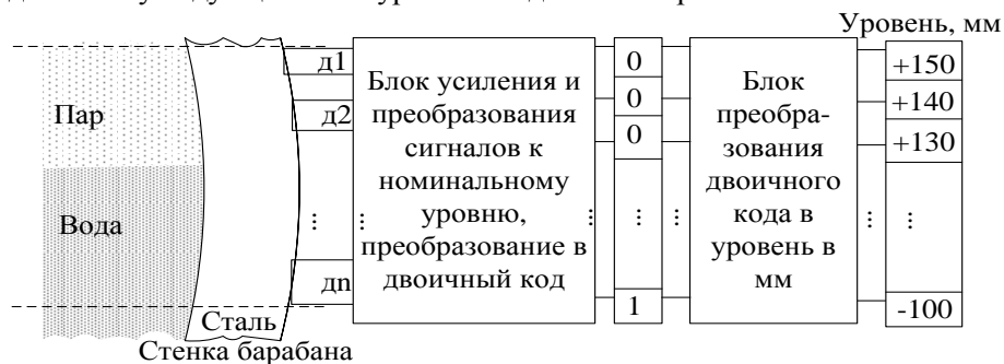
Рис. 1 – Подход к измерению уровня воды по разнице отраженных сигналов от границ раздела сред сталь-вода, сталь-пар
