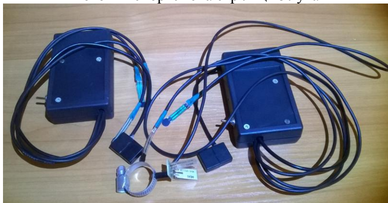
Рисунок 23 – Фотографія багатоканального радіовимірального приладу контролю фізичної підготовки спортсмена стрільця з лука
