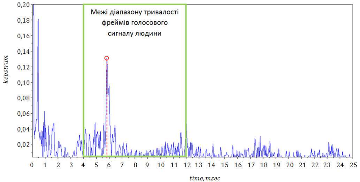
Рисунок 3.18 – Визначення первинної тривалості фреймів голосового сигналу
