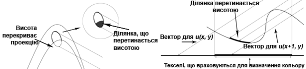
Рисунок 11 – Перекриття частини проекції пікселя більшою висотою
