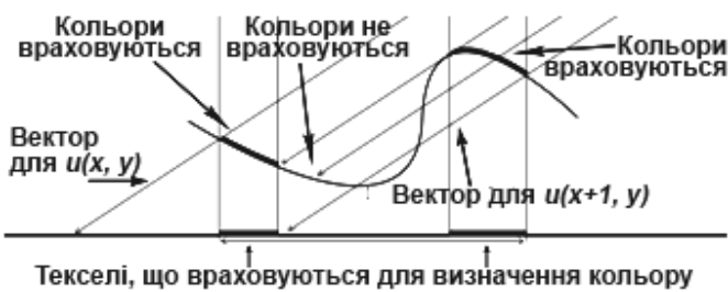
Рисунок 12 – Визначення текселів, що не повинні враховуватись при АФ
