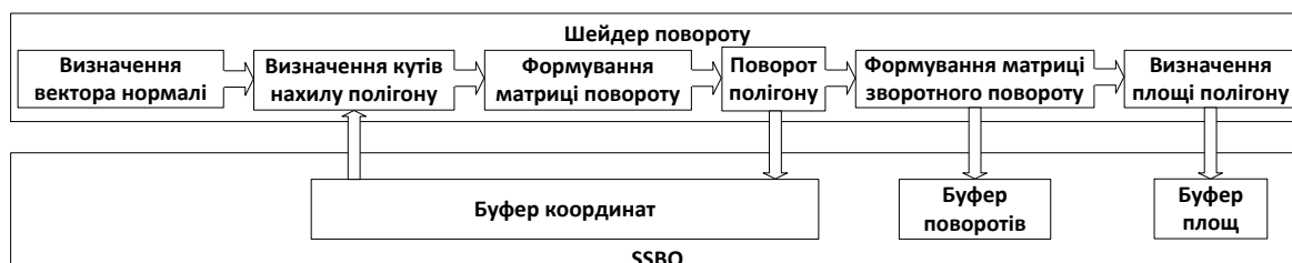
Рисунок 19 – Структура шейдеру повороту
