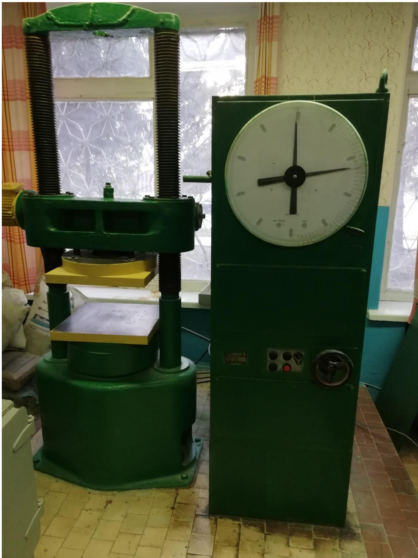
Прес гідравлічний П 125 для визначення міцності та стиск та згин
