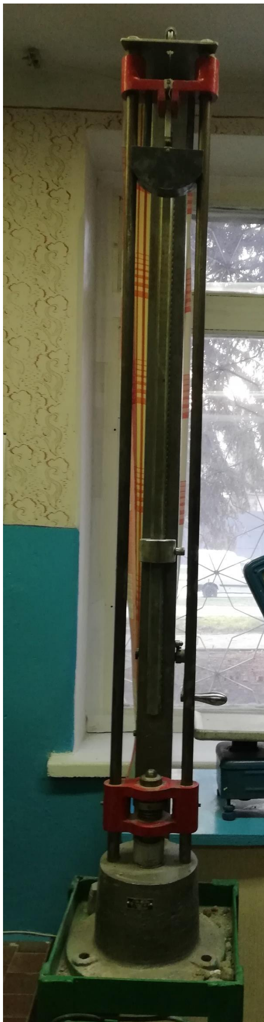
Копер лабораторний КИ для визначення ударної міцності
