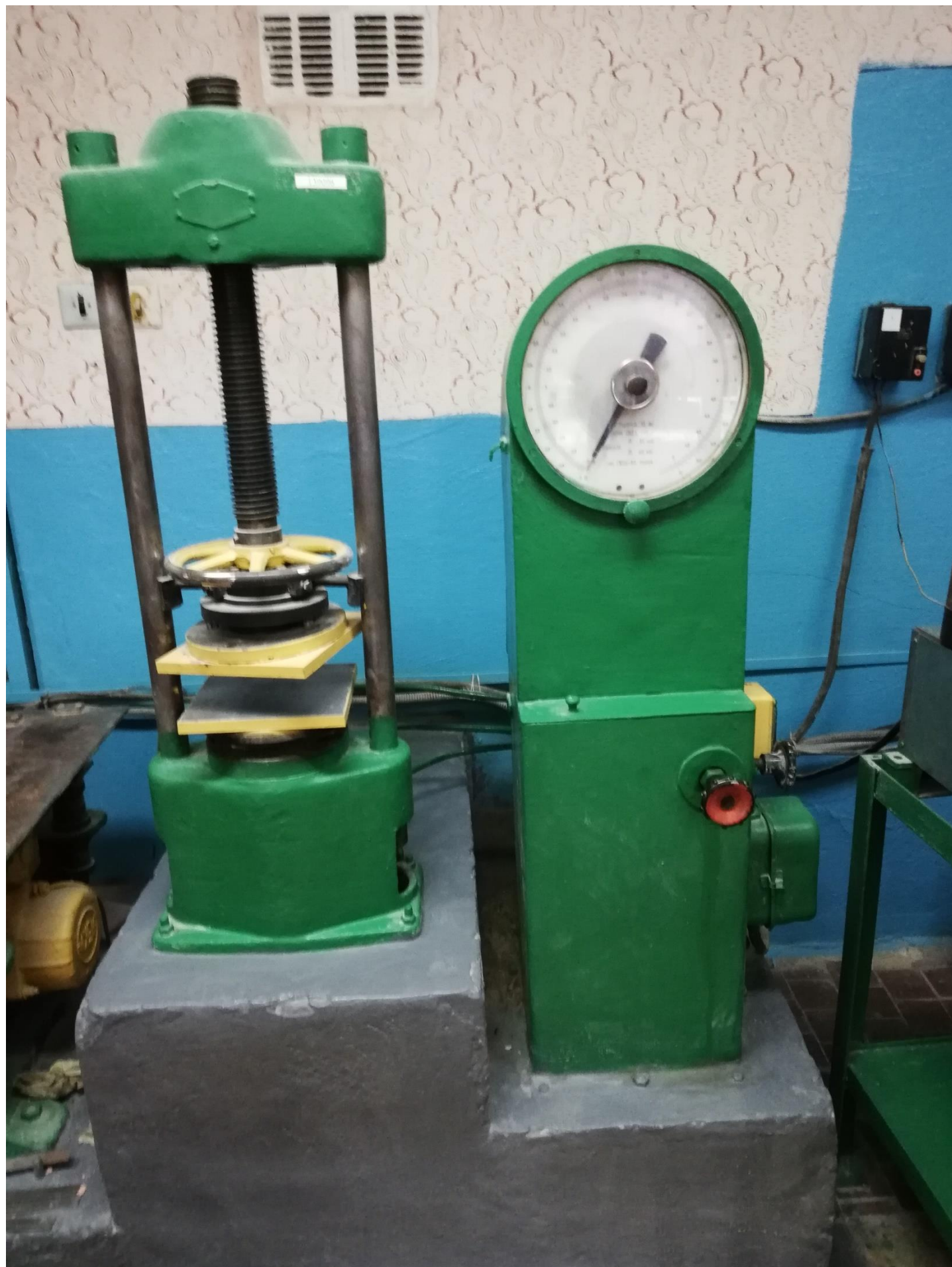
Прес гідравлічний ПСУ 10 для визначення міцності та стиск та згин
